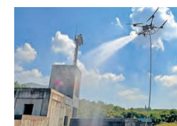
消防用ドローン
